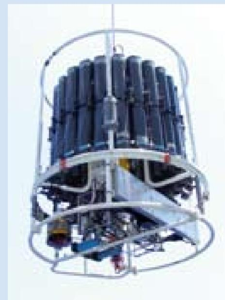
**La plateforme instrumentée inclut des capteurs pour la mesure de la pression, température, salinité, densité, chlorophylle, oxygène, turbidité, une caméra volumétrique pour la mesure du zooplancton et de la neige marine, des bouteilles à déclenchement préprogrammé pour le prélèvement d'eau.**
