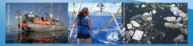
Un filet manta d'un mètre de large placé 20 cm sur et en dessous de la surface de l'eau récoltera le plastique derrière Tara sur des sessions de 15 minutes.
