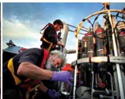
7. Sur le pont arrière, la rosette est remontée. Grâce à ses bouteilles à ouverture pré-programmée, elle a récolté de l'eau à différentes profondeurs et jusqu'à - 2 000 mètres.
