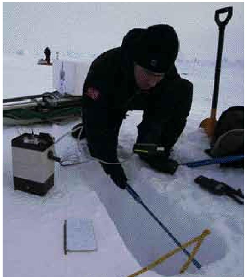
La conductivité thermique de la neige est mesurée à l'aide d'une aiguille chauffée. © Francis Latreille
