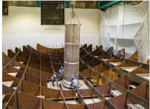
Soudure de la moon-pool et mise en place sur la table de montage. © Fondation Tara Océan
