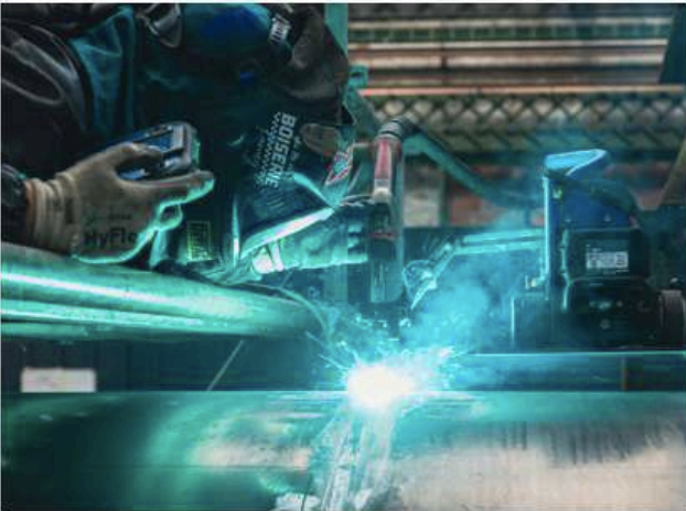
Soudure de la moon-pool et mise en place sur la table de montage. © Fondation Tara Océan
